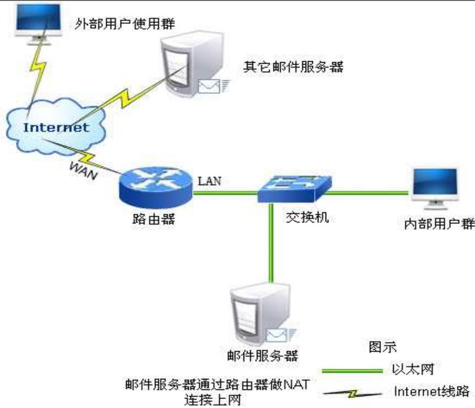
下图为服务器直接连接 Internet 拓扑结构。
